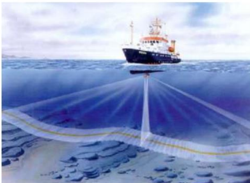
Slika 2.12 Višesnopni dubinomjer (Pribičević, 2005)
