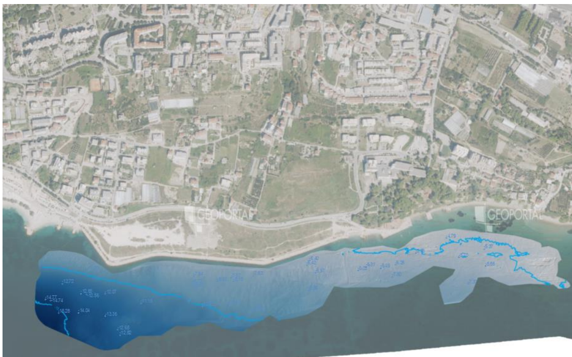
Slika 6.2 Batimetrijska ploha na DOF podlozi
