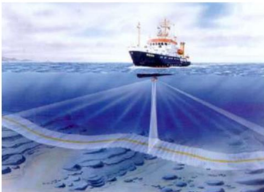
Slika 2.12 Višesnopni dubinomjer (Pribičević, 2005)
