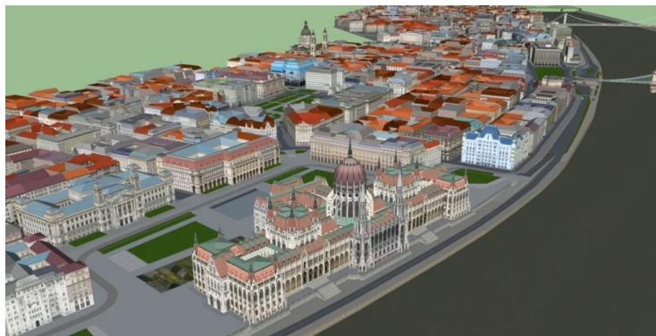
Slika 3.5 3D model grada Budimpešte u SketchUp softveru (URL 15)
