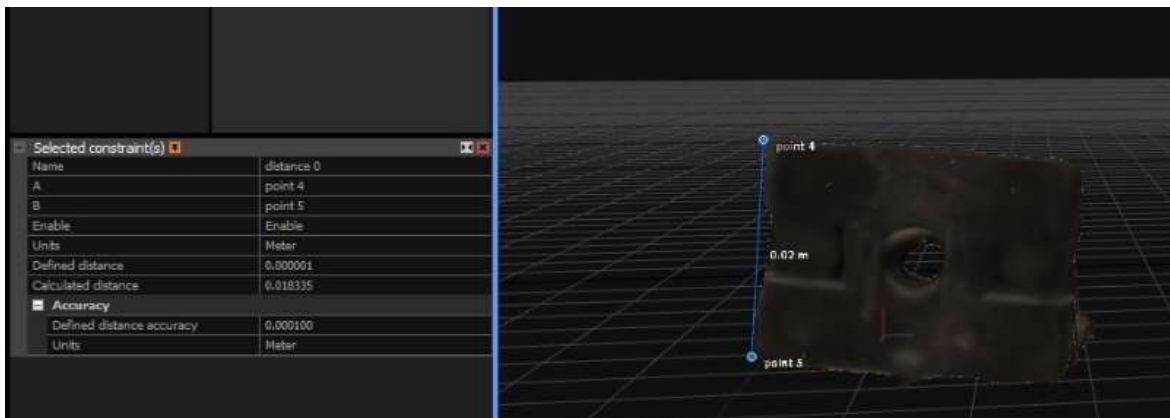
Slika 46. Duljina brida Objekta 2 mjerena na 3D modelu_1
