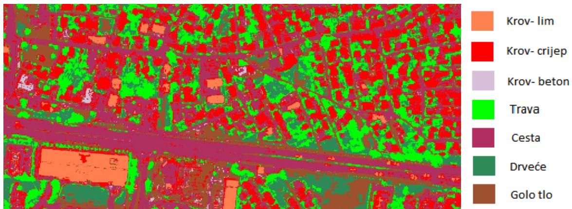
Slika 15. Rezultat klasifikacije multispektralne snimke MLC metodom sa legendom
