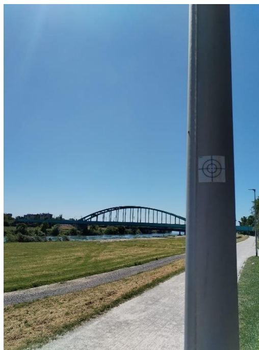
Slika 4.9. Mjerna markica na rasvjetnom stupu.
