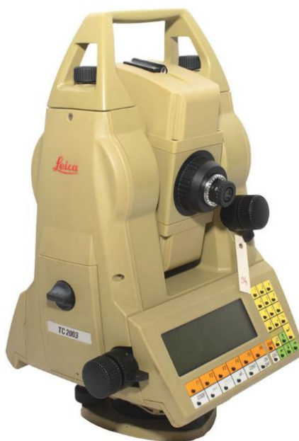
Slika 4.2. Geodetska mjerna stanica Leica TC2003 (URL 5).
