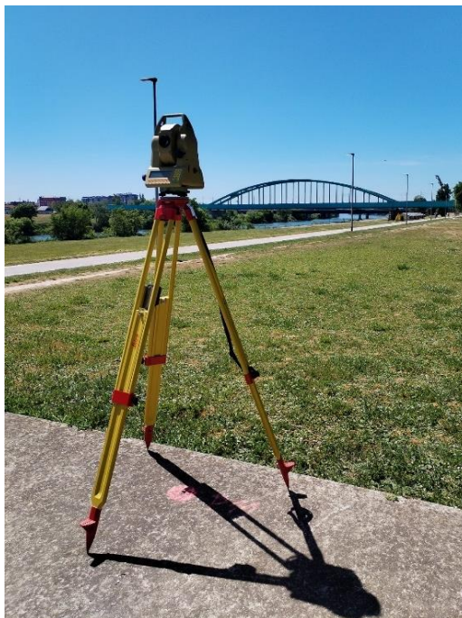
Slika 4.10. Geodetska mjerna stanica postavljena na točki geodetske mikromreže.
