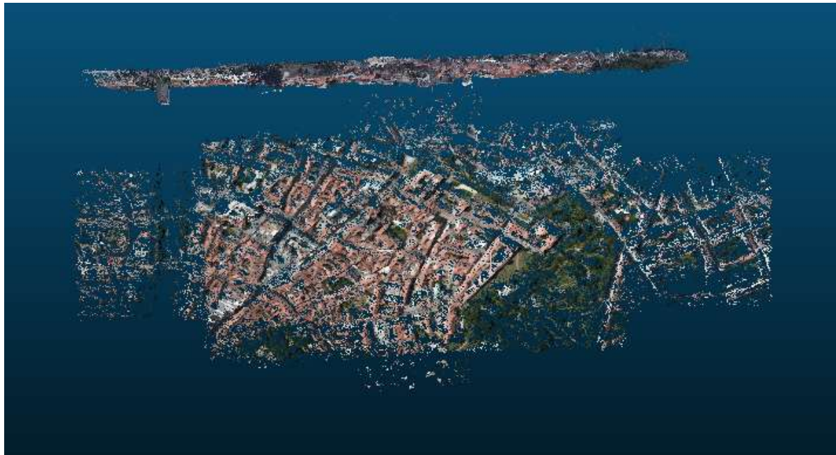
Slika 11.6. Neusklađeni oblaci točaka
