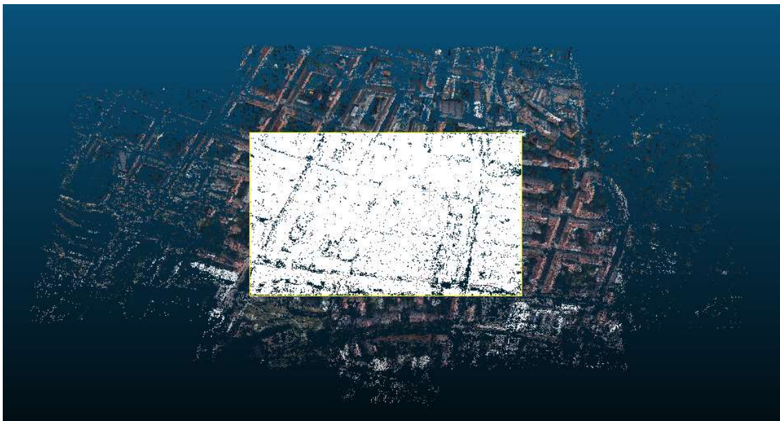
Slika 11.12. Prikaz rezanja drugog oblaka točaka po identičnim granicama
