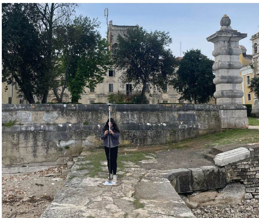
Slika 4.9. Opažanje GCP-a pomoću GNSS uređaja
