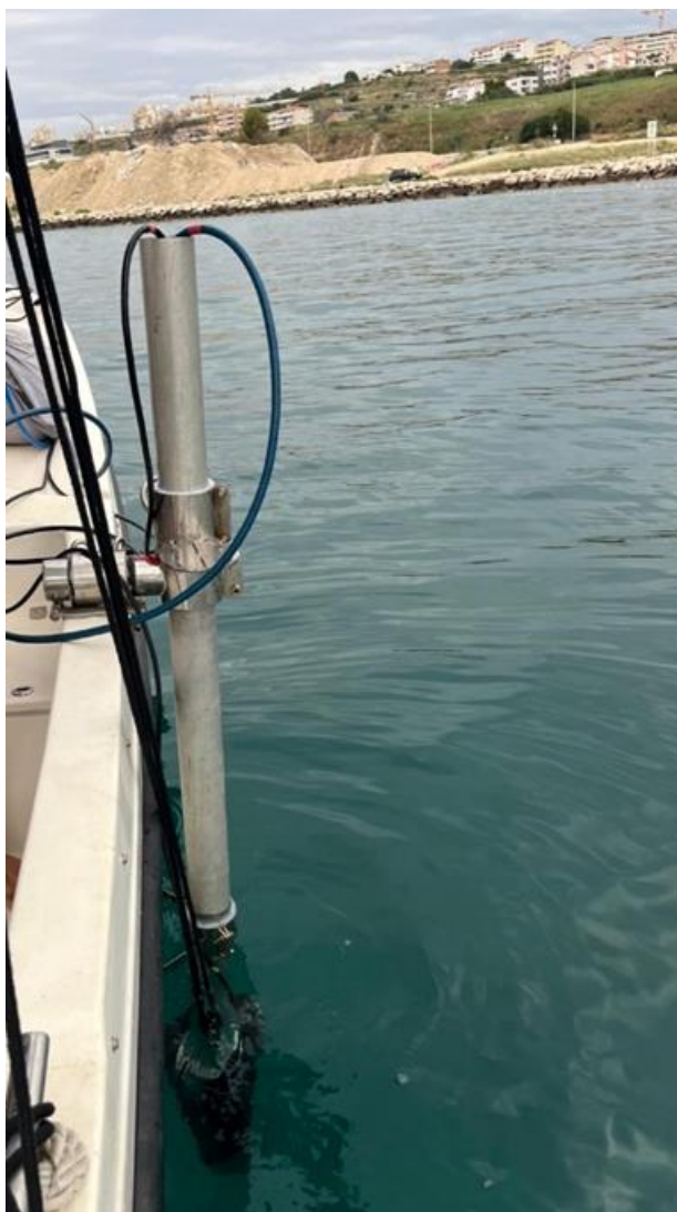
Slika 4.2 Višesnopni dubinomjer montiran na strani broda (izvor: Lovro Klarić)
