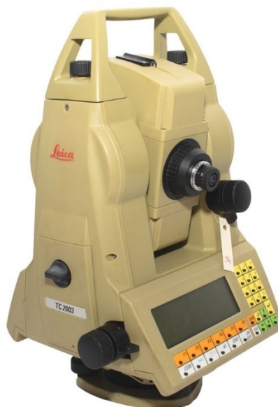
Slika 17. Geodetska mjerna stanica Leica TC 2003 (URL 7).
