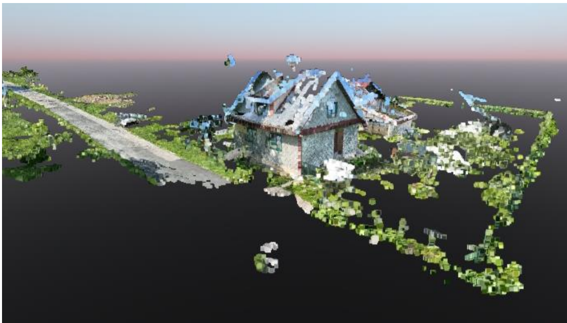
Slika 6.10. Fuzija LiDAR i gustog oblaka točaka
