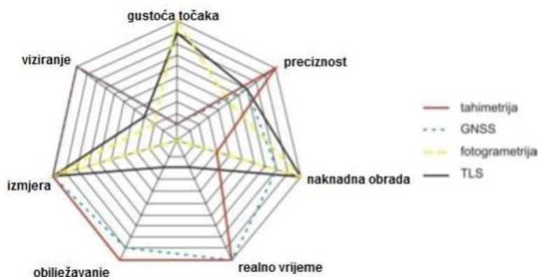
Slika 3.3. Usporedba različitih karakteristika geodetskih metoda izmjere (Zogg, 2008)
