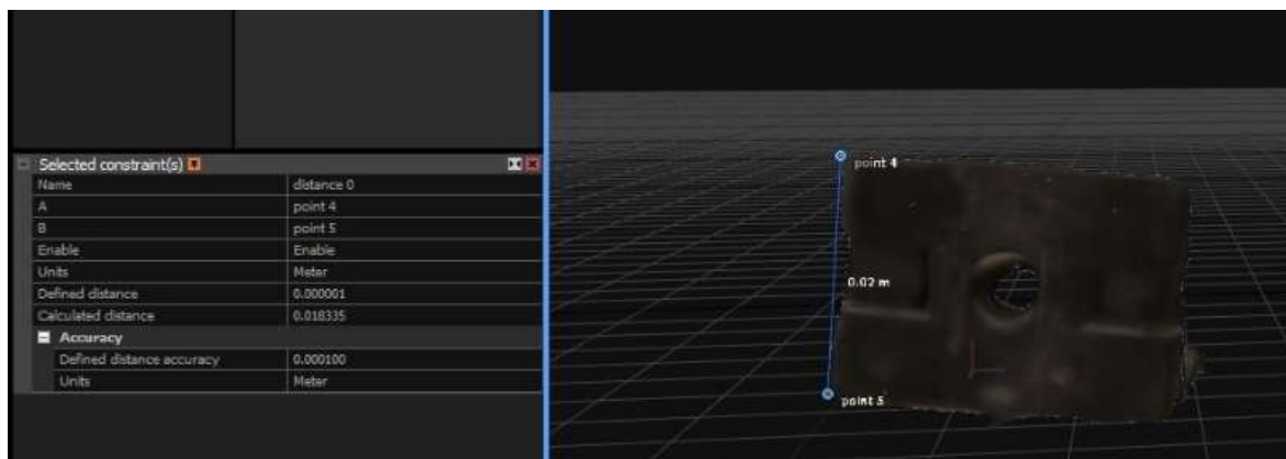
Slika 46. Duljina brida Objekta 2 mjerena na 3D modelu_1
