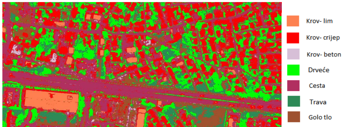
Slika 19. Rezultat klasifikacije skupa multispektralnih kanala i NDVI-a metodom Maximum Likelihood s legendom
