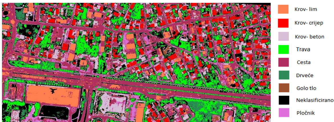
Slika 14. Završna klasifikacije hiperspektralne snimke SAM metodom s uključenim kanalima 7- 31 i dodatnom klasom pločnik sa legendom
