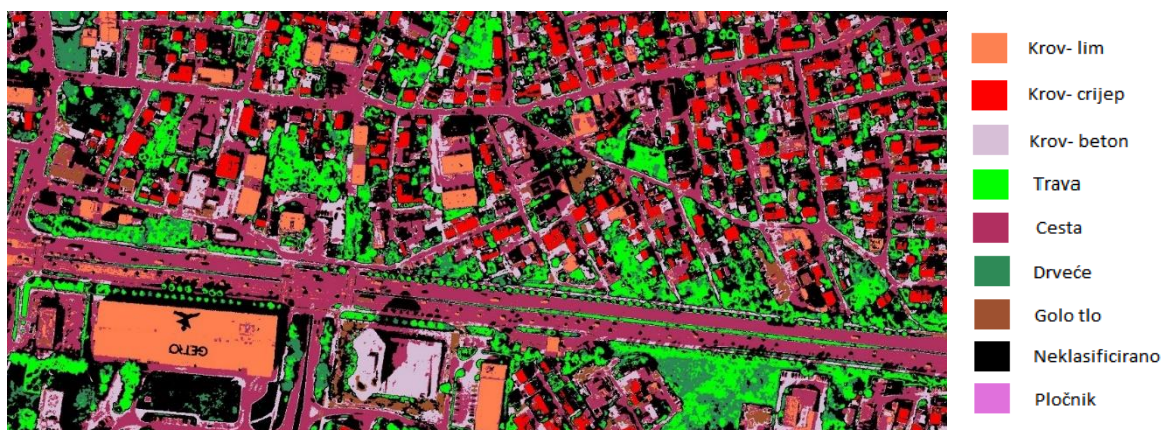
Slika 13 Prva iteracija klasifikacije hiperspektralne snimke SAM metodom s uključenim svim kanalima i bez klase pločnik sa legendom
