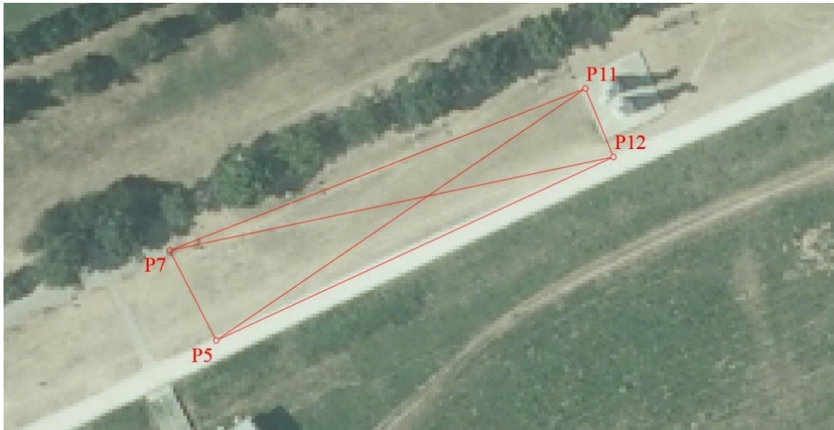
Slika 4.8. Prikaz točaka geodetske mikromreže sa preklopom digitalnog ortofoto-a (DOF).
