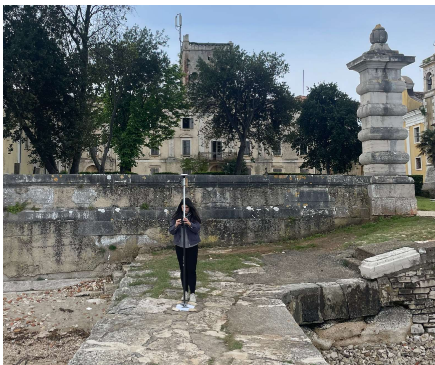
Slika 4.9. Opažanje GCP-a pomoću GNSS uređaja
