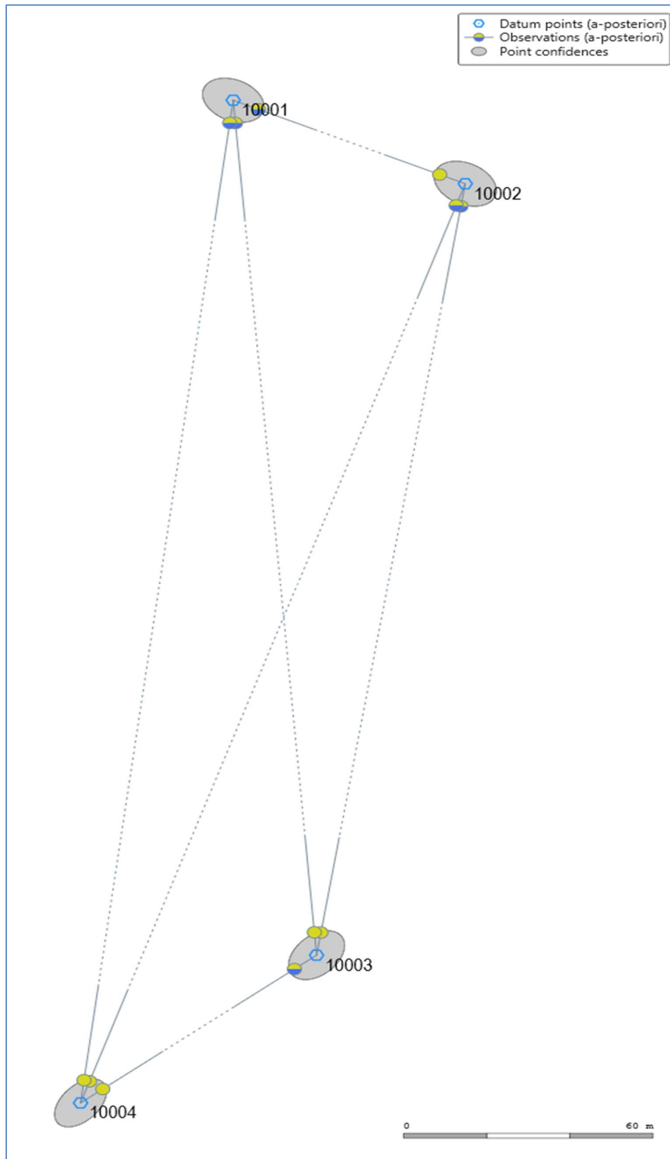
Slika 8.7. Prikaz mreže Bakovac s elipsama pogrešaka u mjerilu 1:2000 nakon simulacije 3
