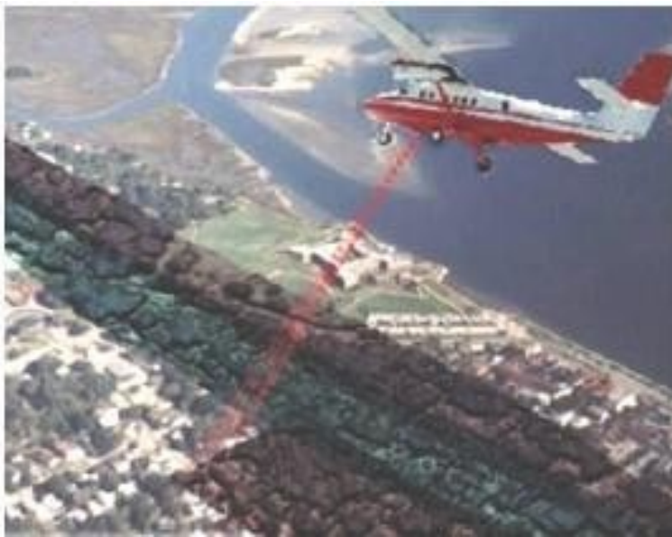
Slika 2.12 Princip snimanja u nizovima (Gajski,2007)
