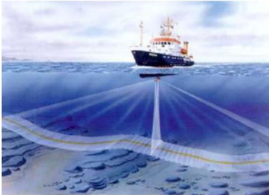
Slika 2.12 Višesnopni dubinomjer (Pribičević, 2005)
