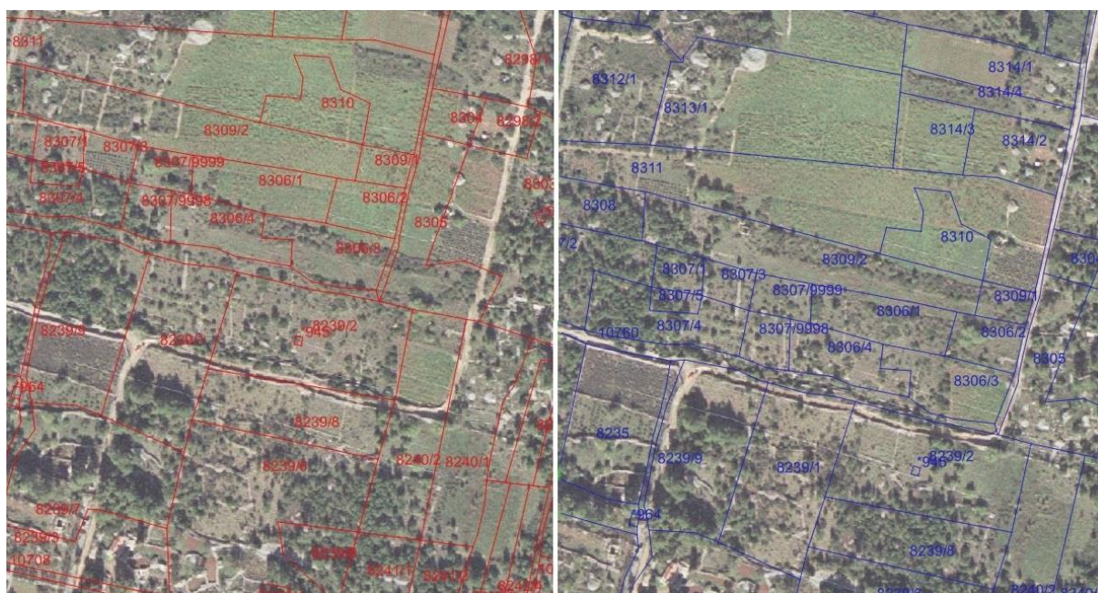
Slika 7.1. Dio VDKP-a prije (lijevo) i nakon (desno) homogenizacije (M 1:2880) – primjer 1
