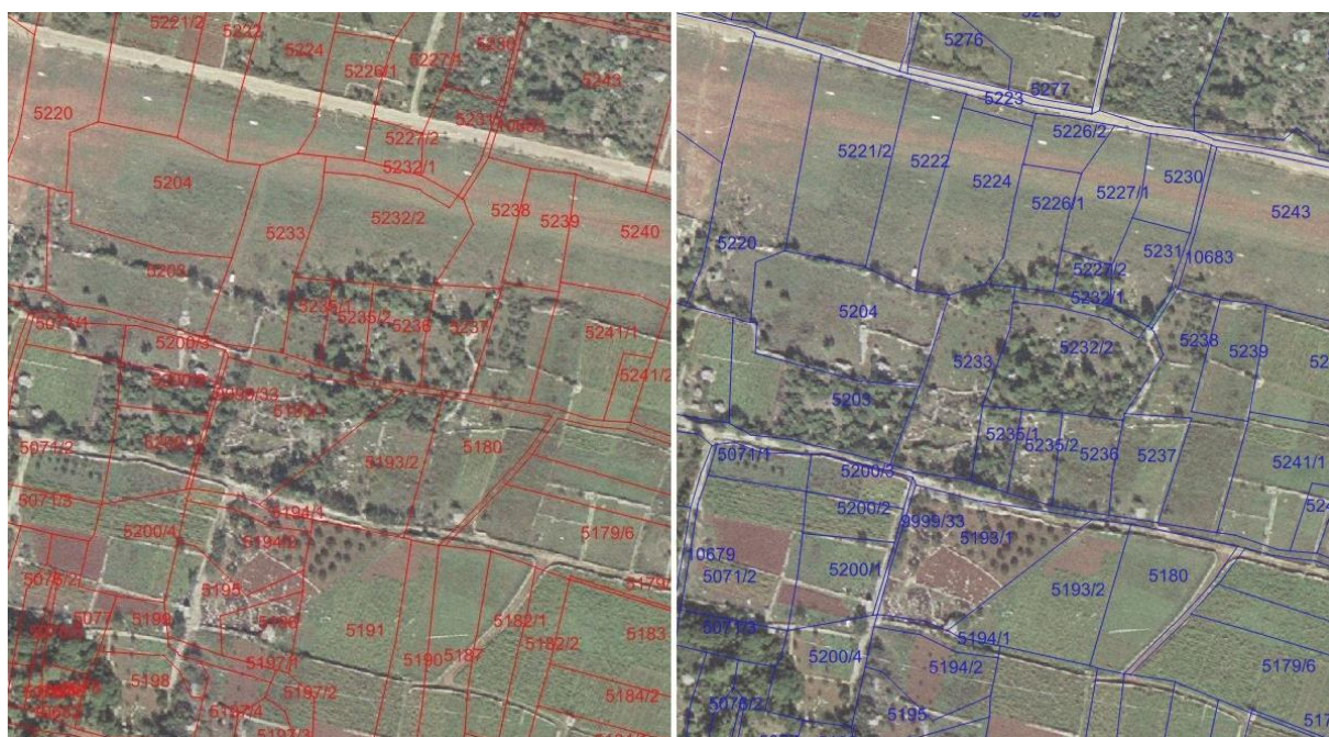
Slika 7.3. Dio VDKP-a prije (lijevo) i nakon (desno) homogenizacije (M 1:2880) – primjer 3
