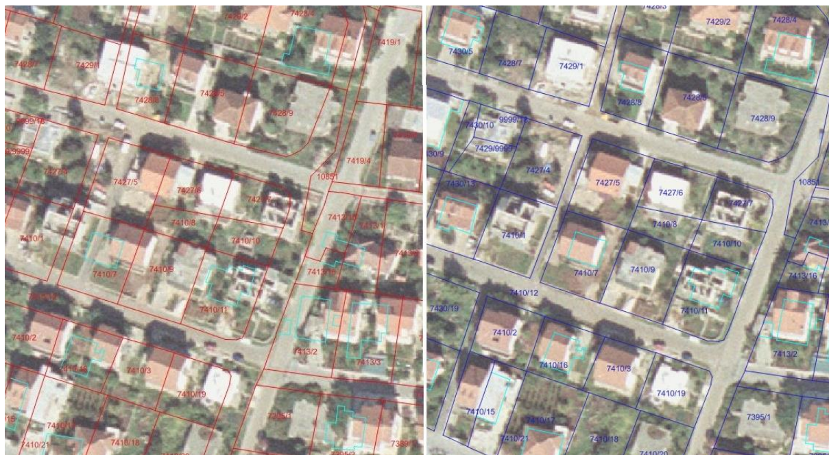
Slika 7.2. Dio VDKP-a prije (lijevo) i nakon (desno) homogenizacije (M 1:1440) – primjer 2
