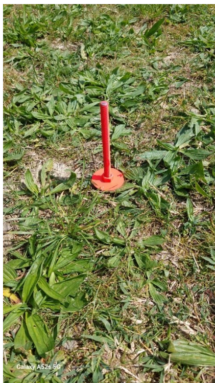
Slika 19. Metalni kolac za iskolčenje.
