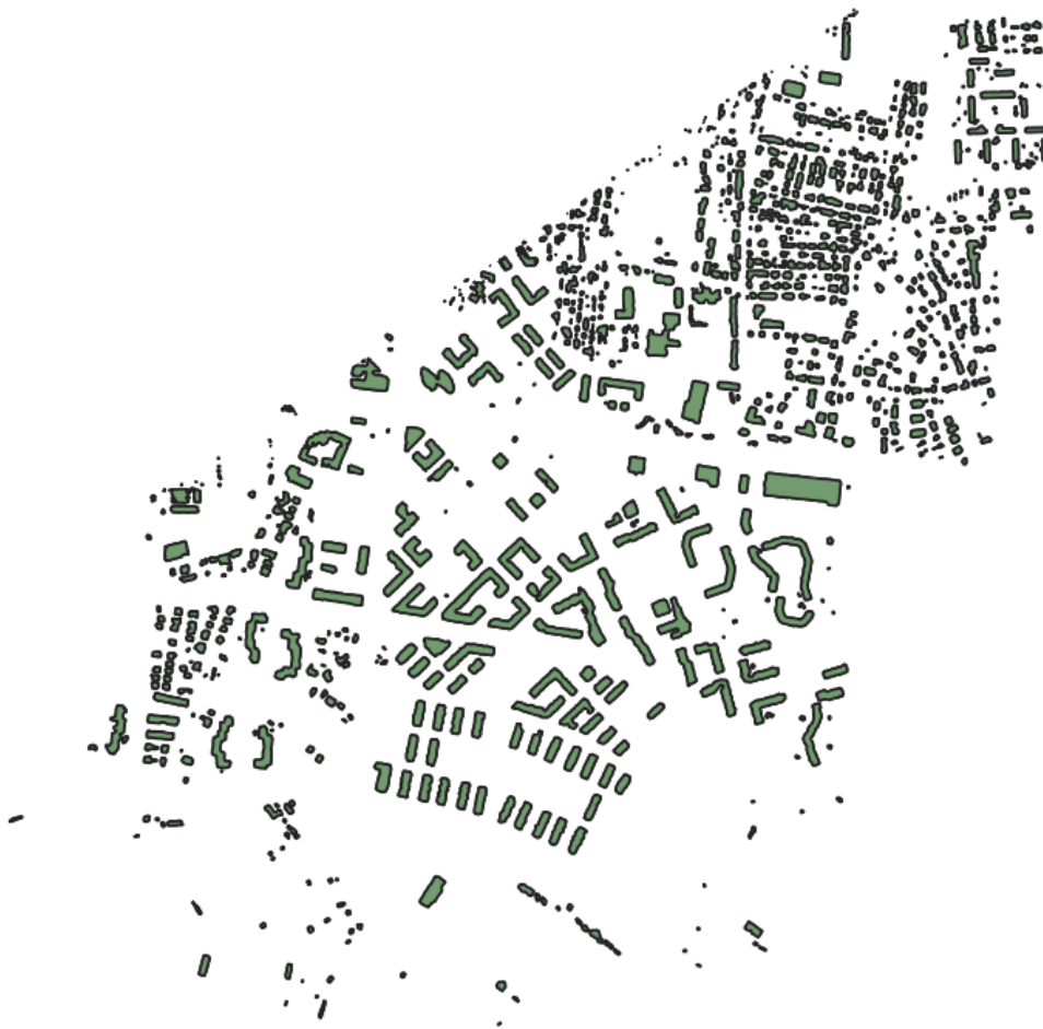
Slika 22 Poligoni dobiveni korištenjem funkcije Concave Hull u QGIS
