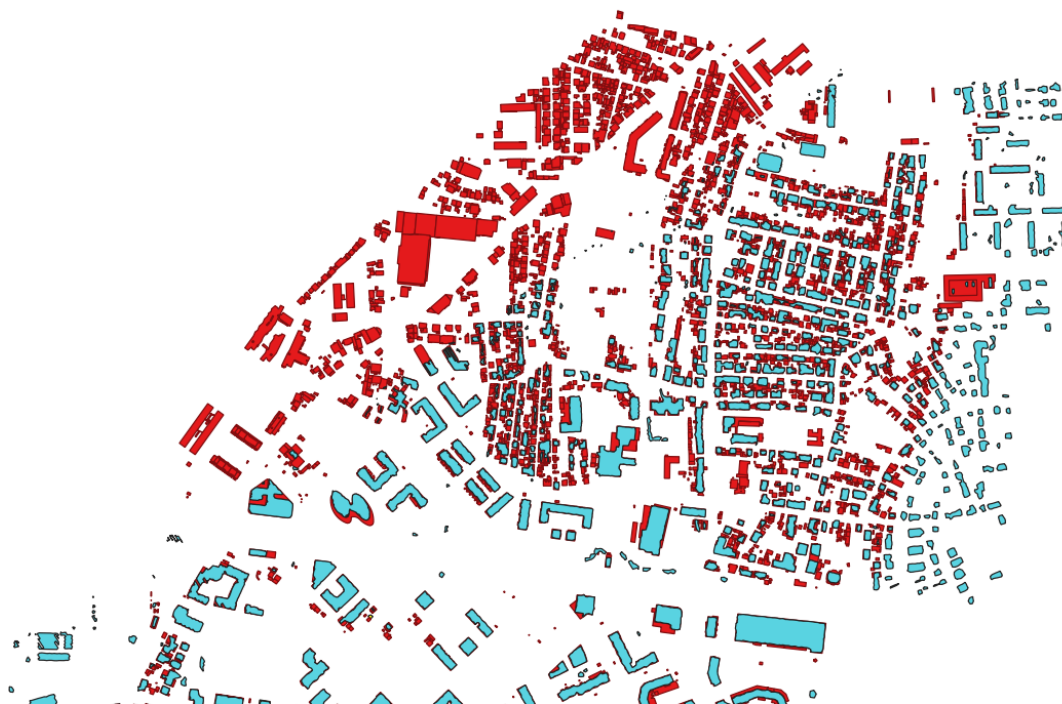
Slika 25 Neslaganje podataka 3D modela i LiDAR podataka
