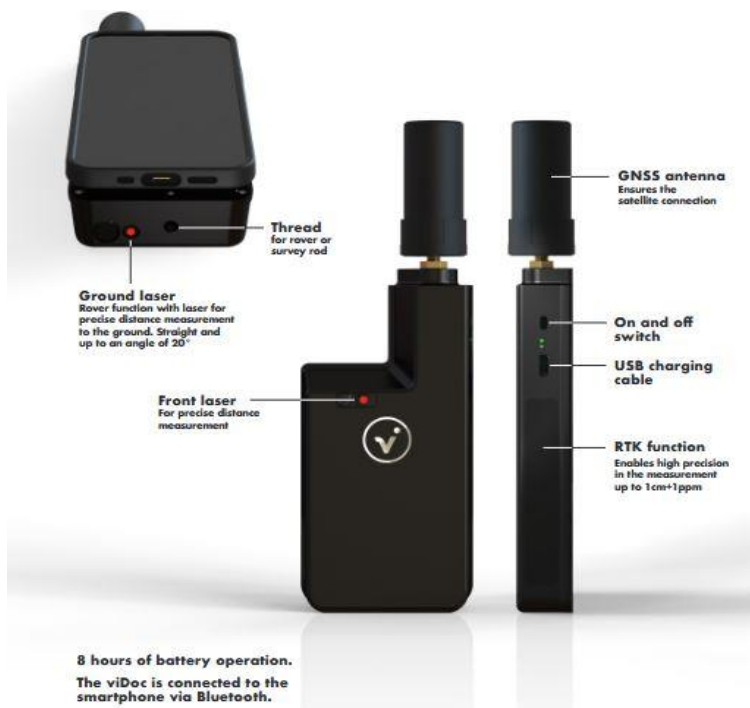
Slika 5.9. Prikaz viDoc RTK rovera uparenog s mobitelom (URL 19)
