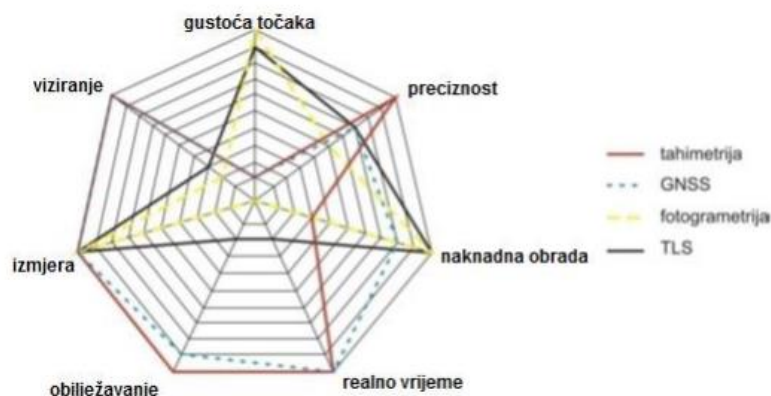
Slika 3.3. Usporedba različitih karakteristika geodetskih metoda izmjere (Zogg, 2008)
