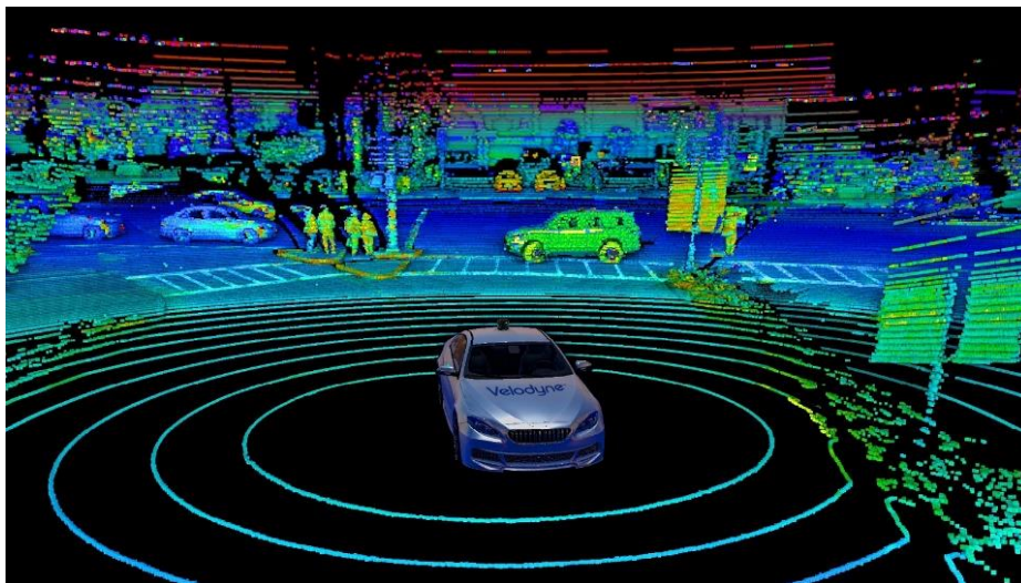
Slika 2.7. Prikaz vidnog polja rotirajućeg LiDAR-a postavljenog na krovu automobila (URL 10)
