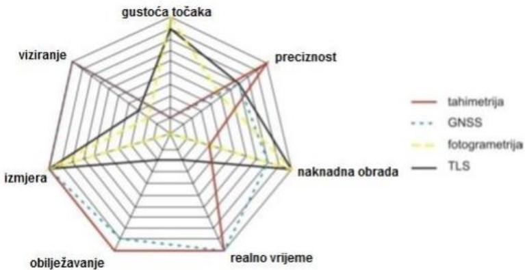
Slika 3.3. Usپoredba različitih karakteristika geodetskih metoda izmjere (Zogg, 2008)
