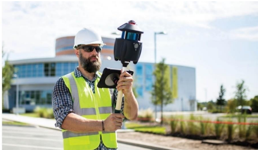
Slika 2.3. LiDAR Paracosm PX-80 realiziran na način da snima dok mjeritelj hoda (URL 4)
