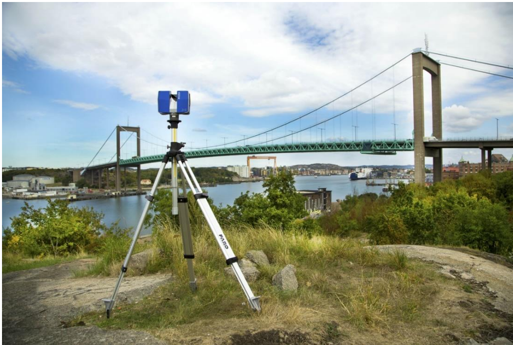
Slika 2.2 Statični laserski skener Faro Focus3D X 330 pri monitoringu mosta (URL 3)
