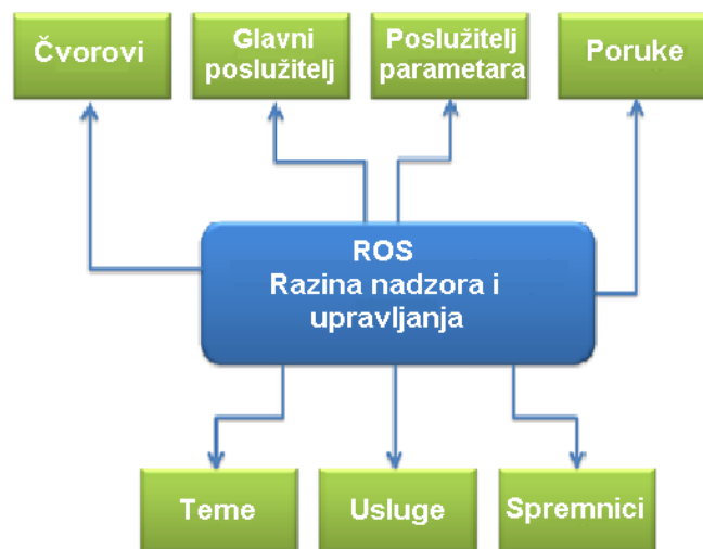
Slika 5.3. Shematski prikaz ROS razine nadzora i upravljanja (prema URL 30)
