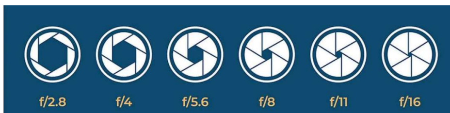
Slika 12. Prikaz objektivu pri snimanju fotografije sa različitim postavkama otvora blende (f-broj) (URL 8)
