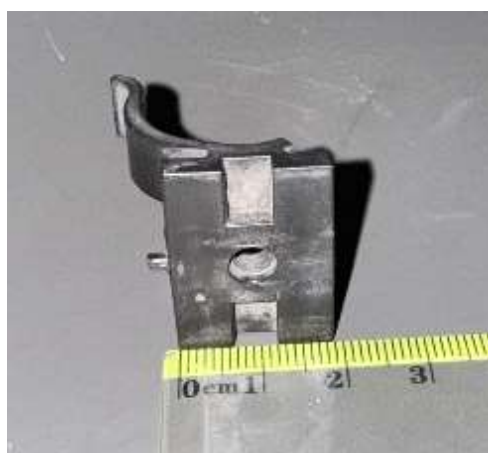
Slika 47. Duljina brida Objekta 2 izravno mjerena na objektu_1
