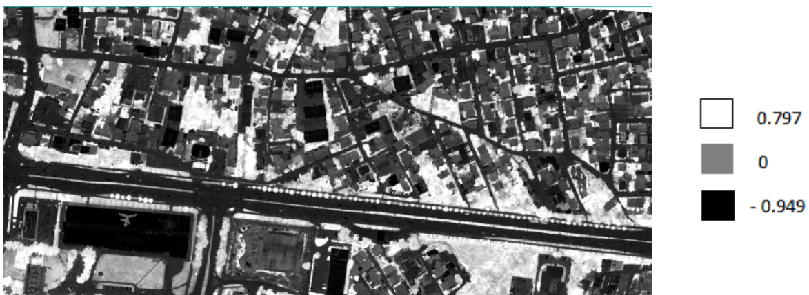
Slika 17. Rezultat izračuna NDVI indeksa na multispektralnoj snimci sa legendom
