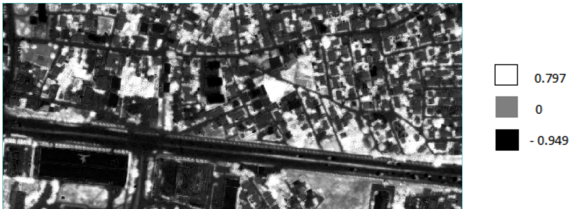
Slika 17. Rezultat izračuna NDVI indeksa na multispektralnoj snimci sa legendom
