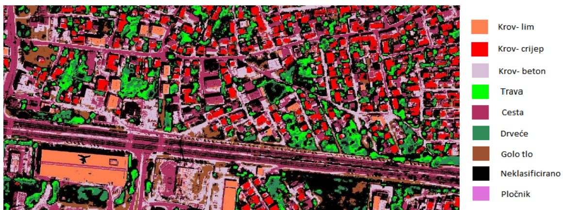
Slika 11. Prva iteracija klasifikacije multispektralne snimke SAM metodom sa legendom
