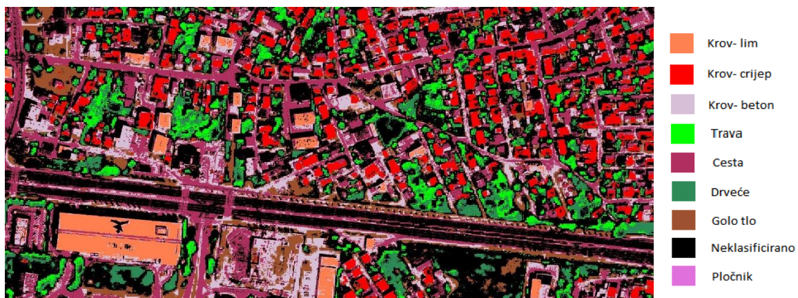
Slika 11. Prva iteracija klasifikacije multispektralne snimke SAM metodom sa legendom
