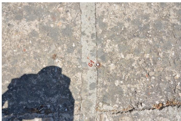
Slika 4.2. Stabilizacija točke G1
