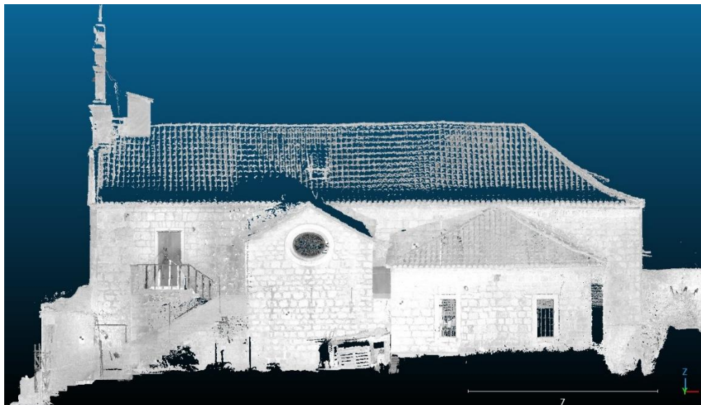
Slika 7.5. Oblak točaka dobiven s terestričkim laserskim skenerom, pogledom s južne strane
