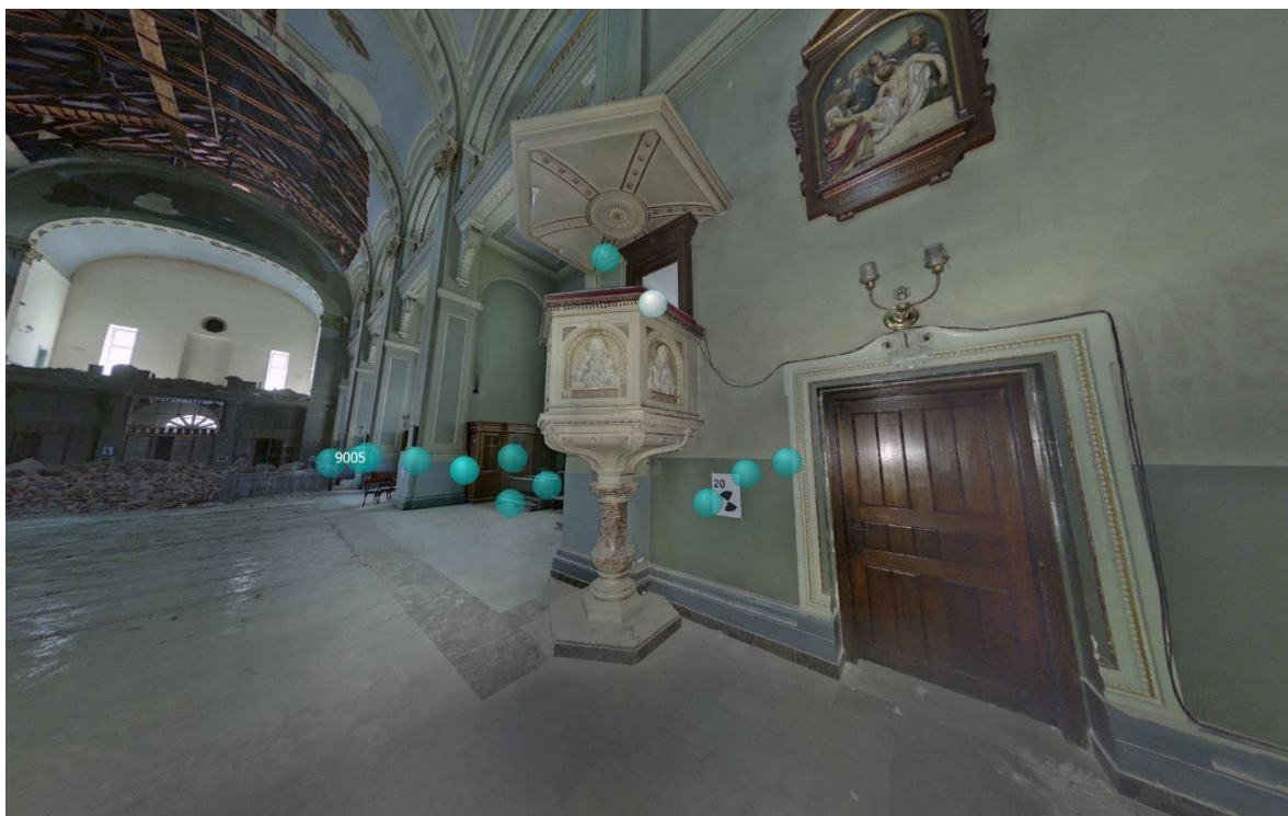
Slika 3.5. Georeferencirani 3D model, pogled sa pozicije stajališta skenera
