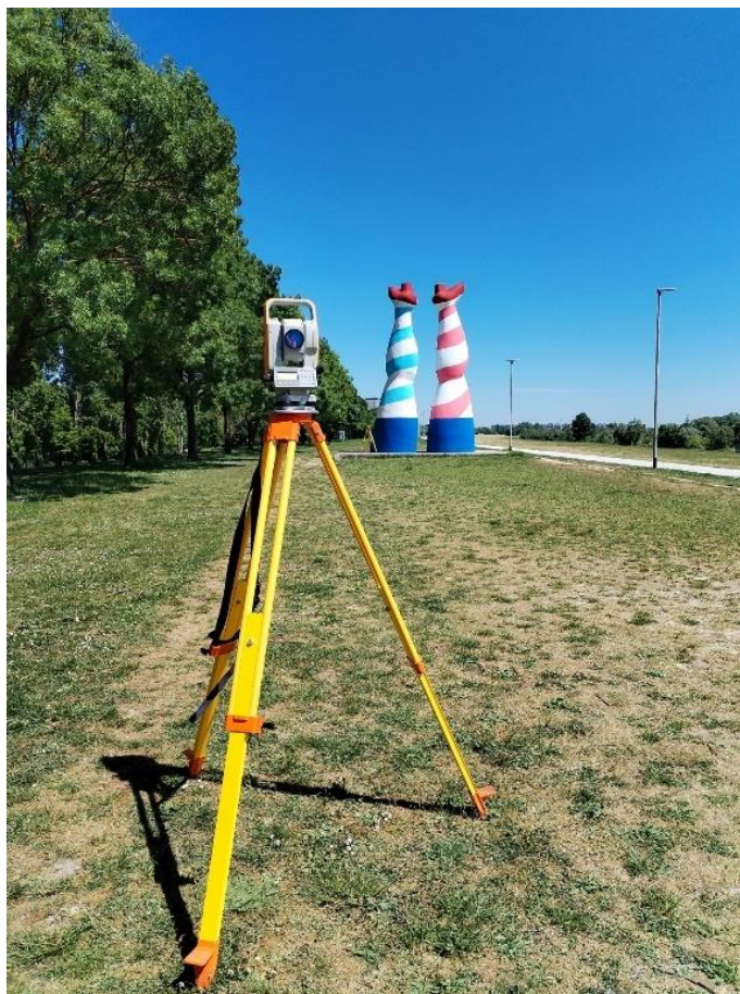
Slika 4.11. Postavljena geodetska mjerna stanica za izmjeru metodom slobodnog stajališta.
