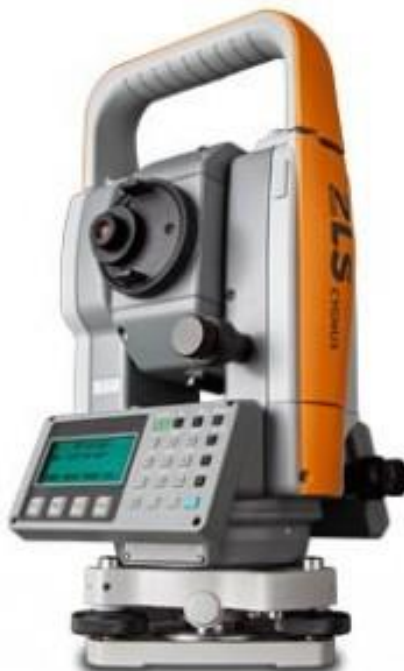
Slika 4.3. Geodetska mjerna stanica Cygnus 2LS (URL 6).
