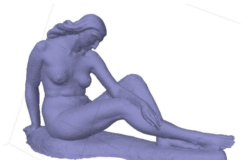
Slika 40. Model izrađen na temelju oblka točaka
