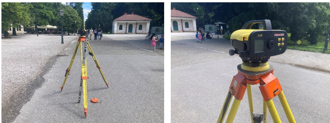
Slika 4.3. Digitalni nivelir Leica Sprinter 150M sa aluminijskom barkod letvom.
