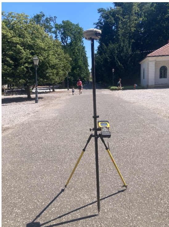
Slika 4.1. GNSS Trimble R8 sa kontrolerom TSC2
