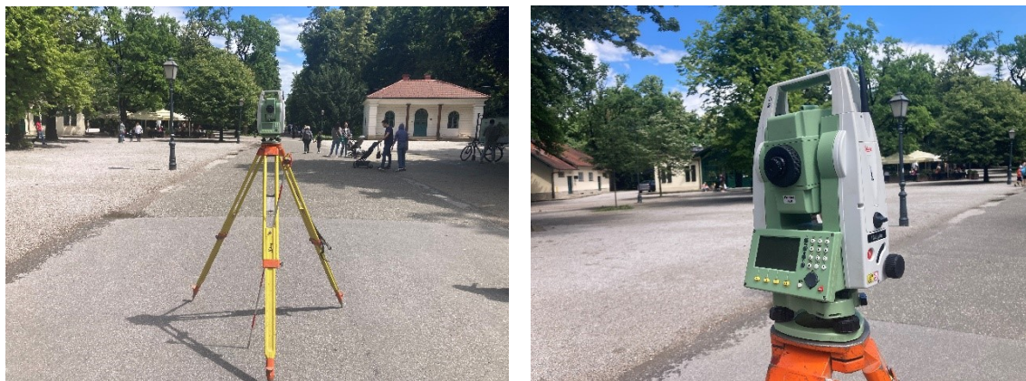
Slika 4.2. Totalna stanica Leica TS06 i mini prizma.
