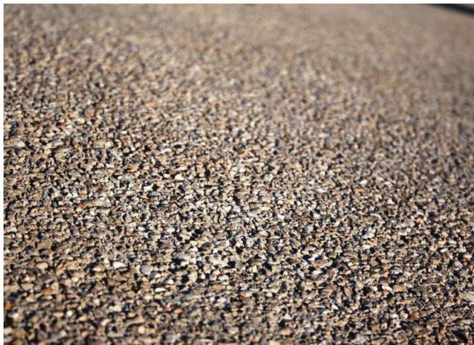
Slika 7.5. Primjer obloge od kulir lijevanog betona – Coolir Basic.
