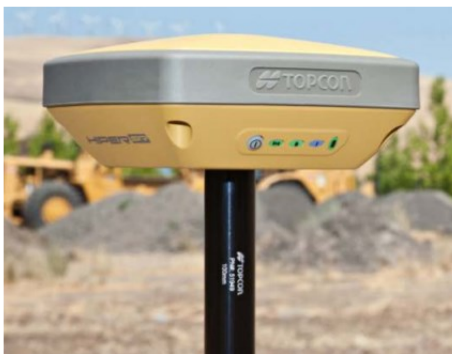
Slika 5.2 Topcon Hiper SR GNSS uređaj (URL18)
