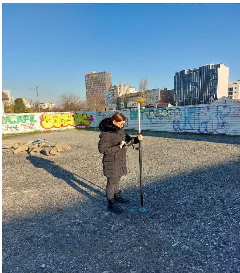
Slika 5.4 Snimanje terena s GNSS uređajem
