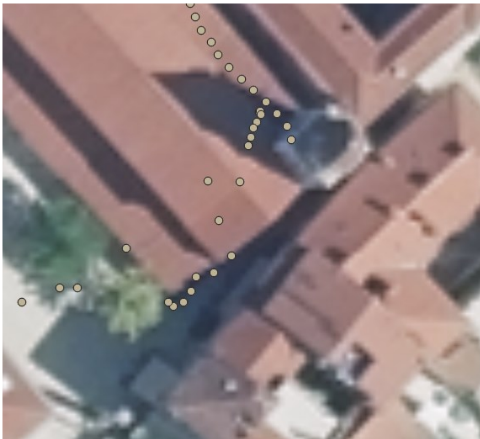
Slika 4.7. Primjer mjerenja sa lošom položajnom točnošću
