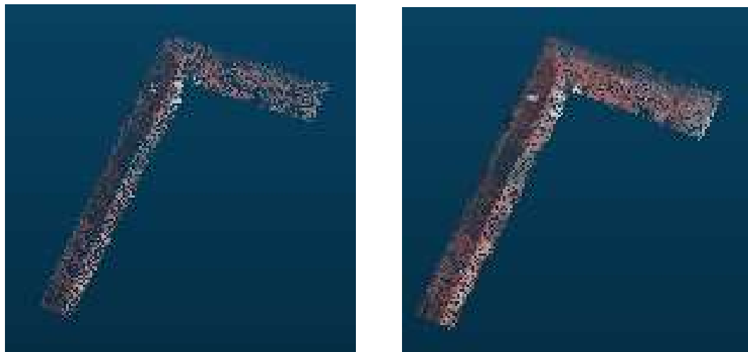
Slika 12.3. Izrezana zgrada iz vertikalnih snimki (lijevo) i kosih snimki (desno)
