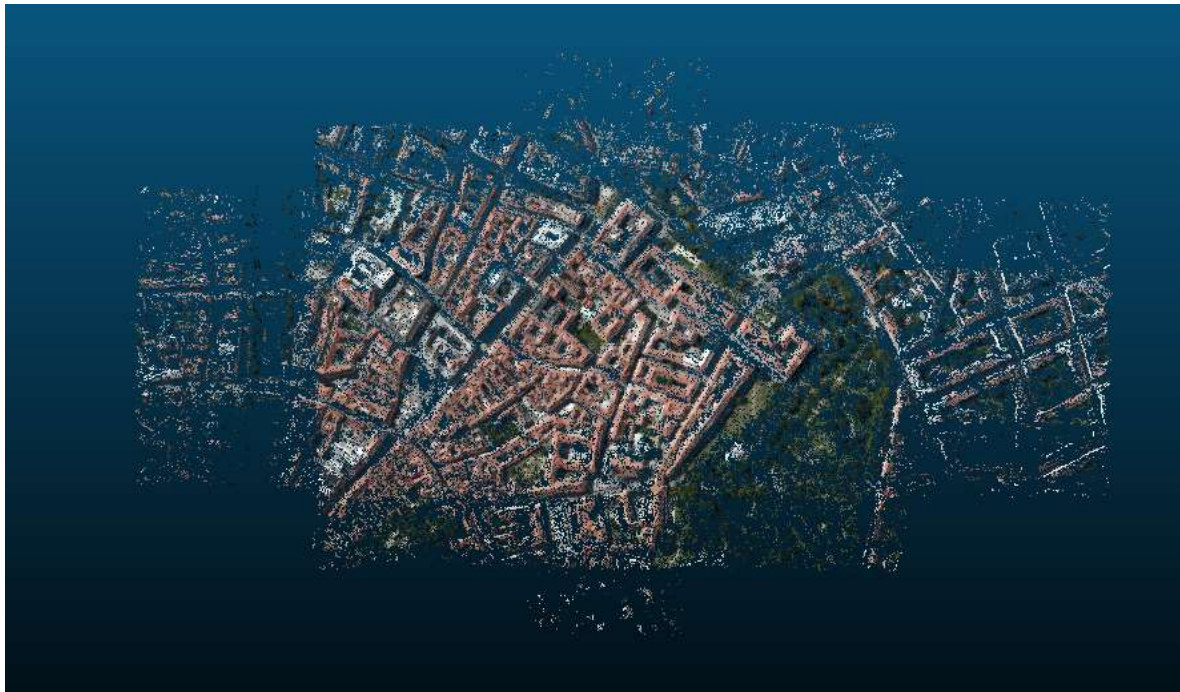
Slika 11.3. Oblak točaka iz vertikalnih snimki
