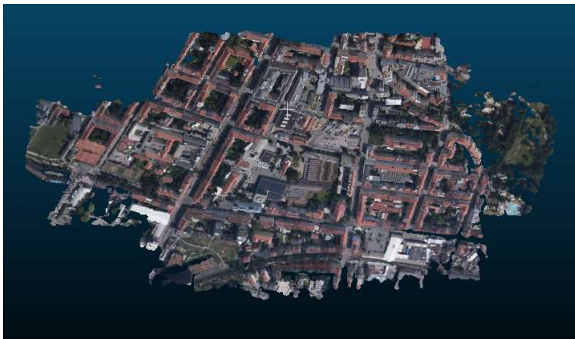
Slika 11.5. 3D model iz kosih snimki
