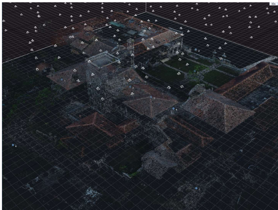
Slika 5.15. Prikaz GCP-a nakon poravnanja
