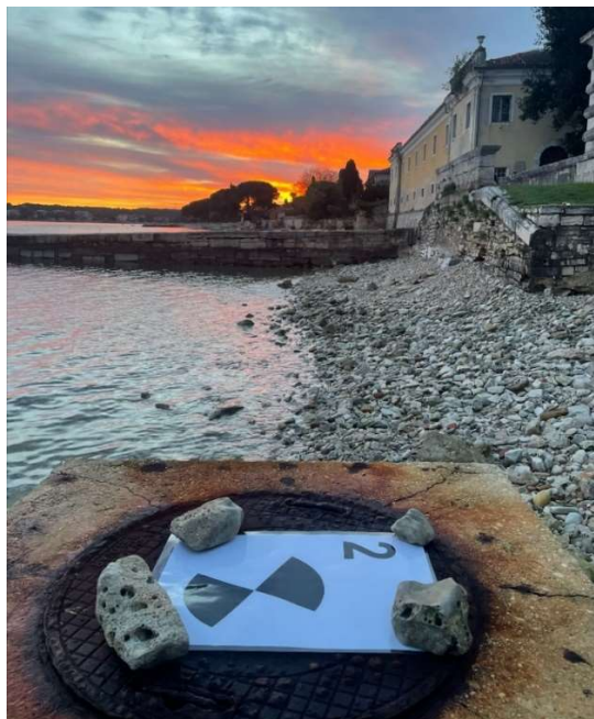
Slika 4.8. Prikaz signalizacije GCP-a na terenu
