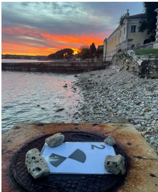
Slika 4.8. Prikaz signalizacije GCP-a na terenu
