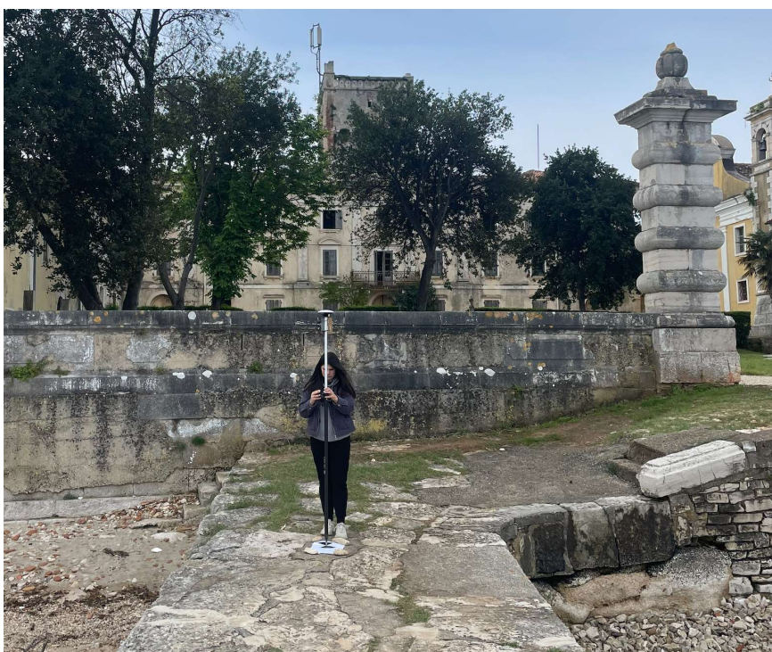
Slika 4.9. Opažanje GCP-a pomoću GNSS uređaja
