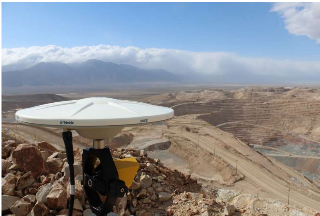
Slika 3.4. GNSS opažanje referente točke geodetske mreže za posebne namjene
