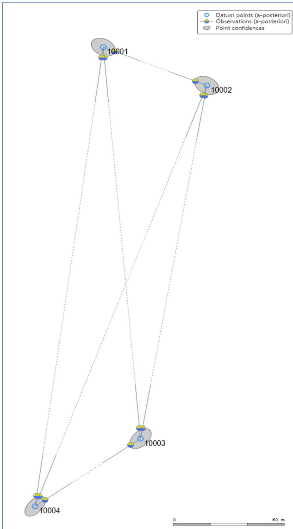
Slika 8.8. Prikaz mreže Bakovac s elipsama pogrešaka u mjerilu 1:2000 nakon simulacije 4
